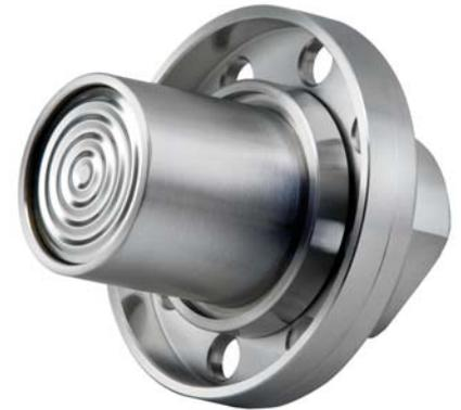
Druckmittler sind Trennvorlagen, die ein Eindringen von korrosiven, viskosen, aggressiven oder zu heißen Prozeßmedien in das Meßelement des Druckmeßgerätes verhindern. Eine Membrane ist an das Druckmittleroberteil angeschweißt und trennt das Prozeßmedium vom Druckmeßgerät ab. Die frontbündige Ausführung der Membrane ermöglicht eine einfache Reinigung der Oberfläche. Eine Auswahl von Anschlußstücken zum Anschweißen oder Anflanschen der Druckmittler an Rohrleitungen stehen zur Verfügung.
